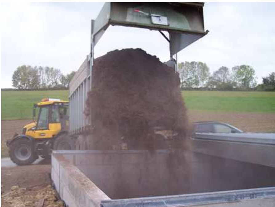
Holz hackschnitzel werden in den Vorratsbunker angeliefert (Bild aus dem Bioenergiehof Mauenheim)
